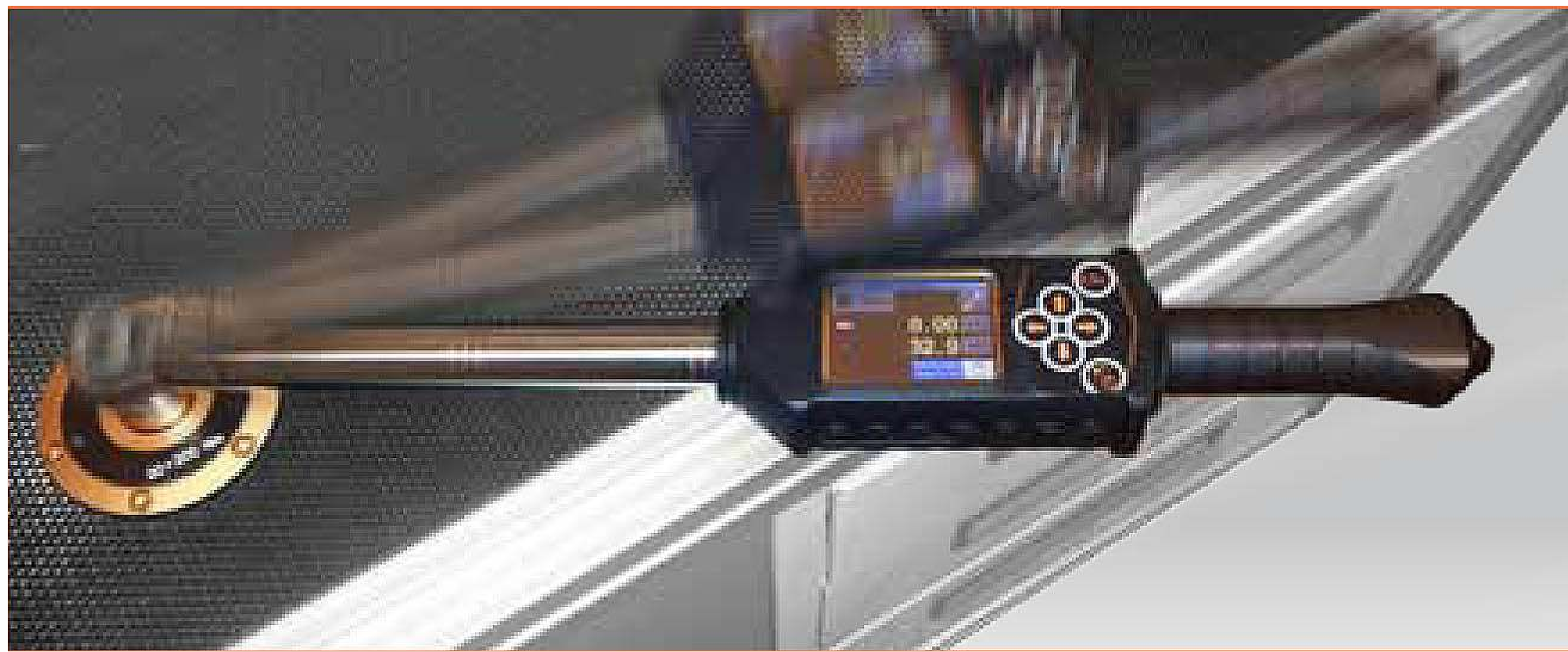
Ručný test krútiaceho momentu / uhlu pre elektronické kľúče.
